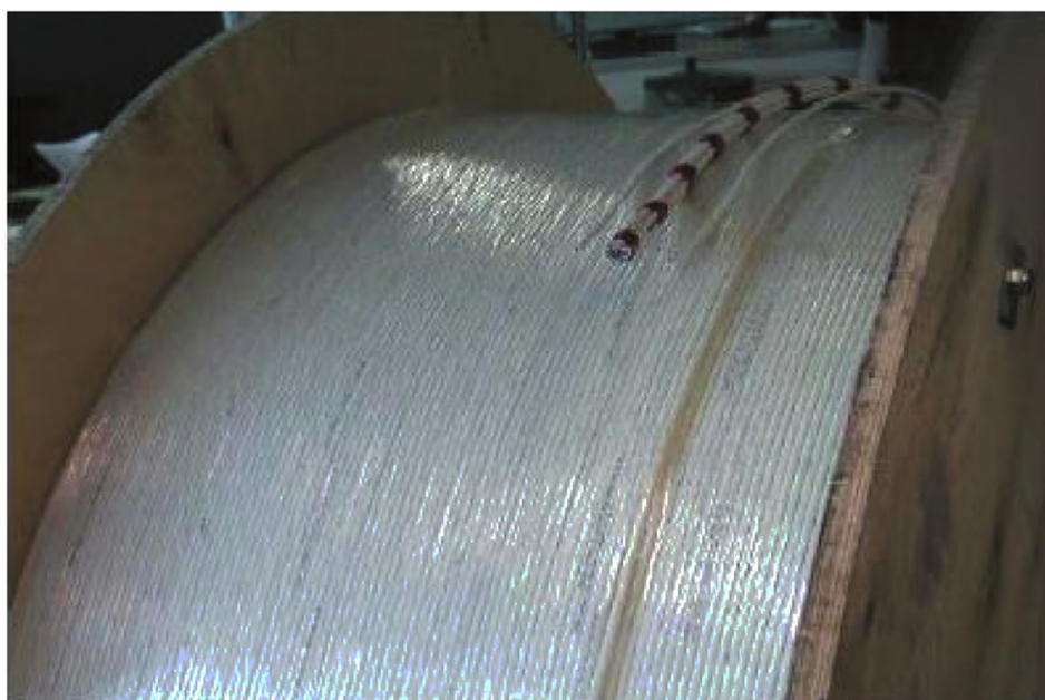
Рисунок 18 — Схема укладки кабелей на барабане
